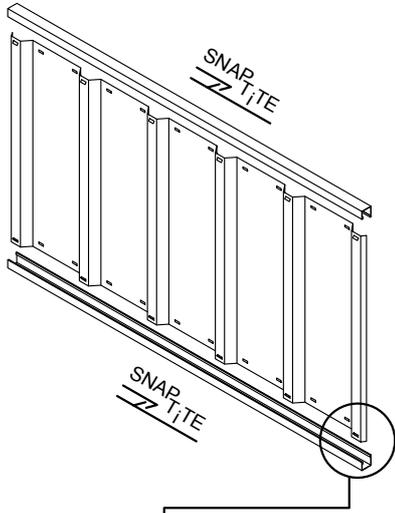
Afin de préassembler les quatre panneaux de paroi et les deux panneaux de toiture, les profilés en U s'enclenchent en haut et en bas de chacun des panneaux à l'aide du système Snap Tite, tel qu'illustré sur les pages suivantes lorsque vous verrez le symbole:
