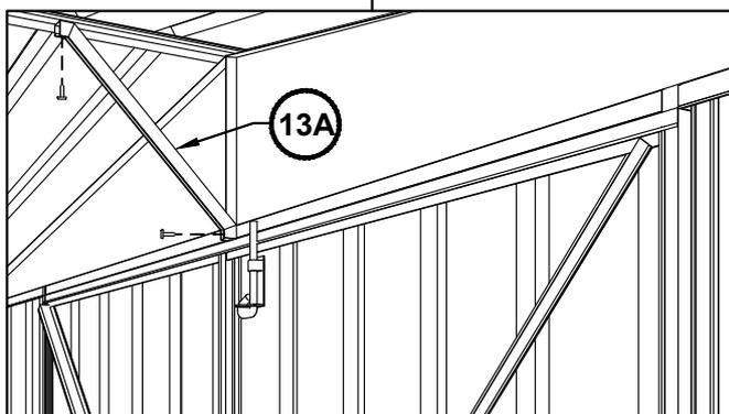
APRÈS AVOIR FIXÉ LES DEUX PANNEAUX DE TOIT AUX PAROIS TEL QU'ILLUSTRÉ CI-DESSUS, FIXEZ UN CONTREVENT REGENT AU FAÎTAGE ET À LA PAROI AVANT TEL QU'ILLUSTRÉ. VOUS DEVREZ RETIRER ET REMPLACER LES VIS SE TROUVANT ACTUELLEMENT AUX EMPLACEMENTS DE FIXATION. FAITES DE MÊME POUR LE CONTREVENT REGENT DE LA PAROI ARRIÈRE.
