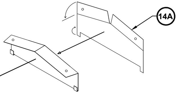
PLIEZ LES AILES SUPÉRIEURES ET INFÉRIEURES TEL QU'ILLUSTRÉ, PLACEZ LES AILES INFÉRIEURES SOUS LES SOLINS D'EXTRÉMITÉ DE LA TOITURE (PIÈCE 87B) ET FIXEZ LES AILES SUPÉRIEURES À L'AIDE DE VIS TEL QU'ILLUSTRÉ POUR LES DEUX PROTECTIONS DE PIGNON.
