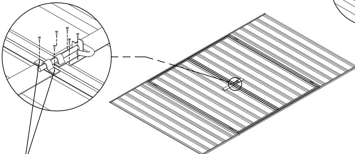
REMARQUE : les deux trous nécessaires à la fixation du morillon du loquet pour chacune des portes n'ont pas été préperforés pour que vous puissiez les aligner correctement. Placez les morillons au centre par rapport à la tige du loquet, percez des trous de 3 mm et fixez-les à l'aide de vis.
