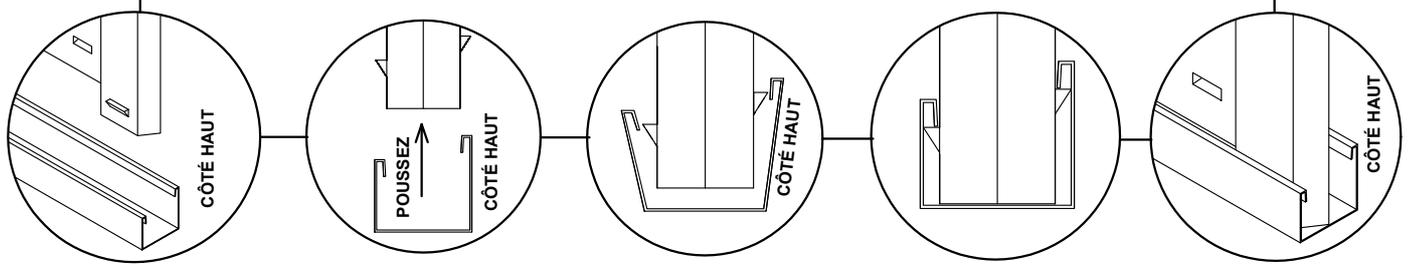
Après avoir assemblé les tôles, placez le profilé en U à une extrémité des tôles, puis tapez doucement dessus afin de l'enclencher, de part et d'autre de la tôle.
