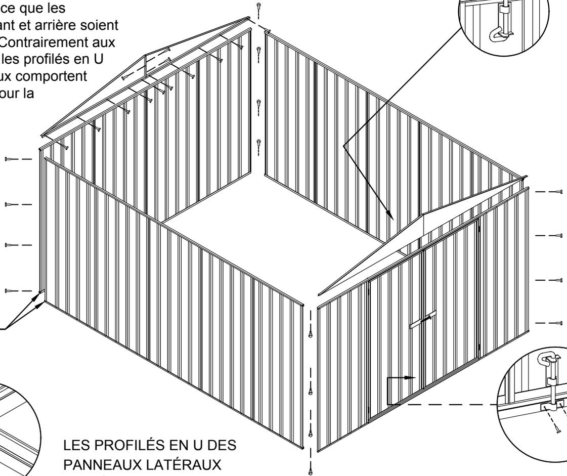
LES PROFILÉS EN U DES PANNEAUX LATÉRAUX S'INSÈRENT DANS LES PROFILÉS À ENCOCHE DES PANNEAUX AVANT ET ARRIÈRE.
