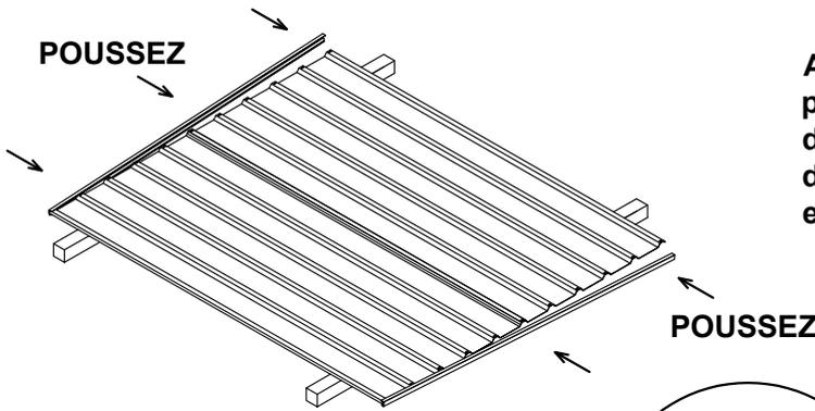
Posez les tôles sur des poutres, des tréteaux ou en partie sur la dalle de béton.
