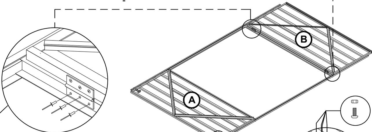
REMARQUE : il est possible d'utiliser des écrous et boulons (fournis) à la place des rivets pop (fournis). Pour cela, il faut agrandir les trous de fixation des charnières qui se trouvent sur le montant à l'aide d'un foret de 4mm.
