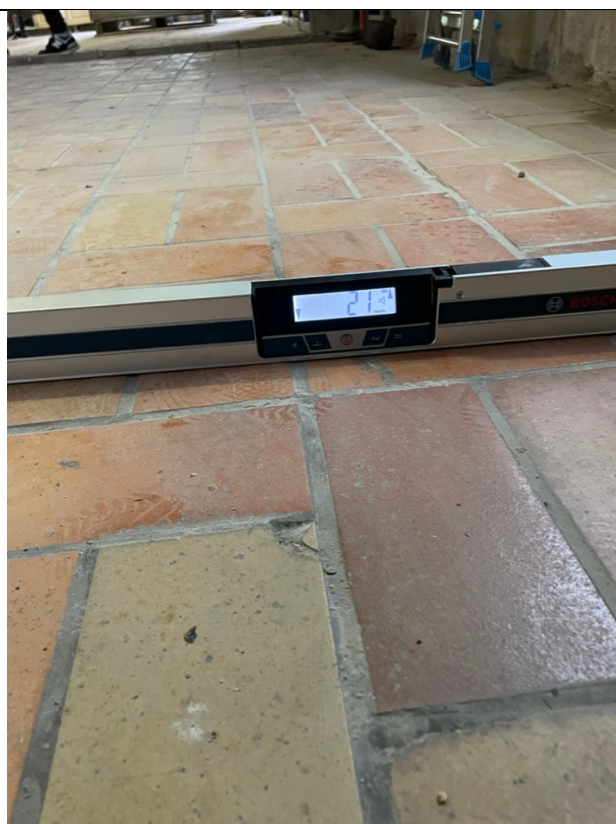
Photo 11 : inclinaison sol garage
