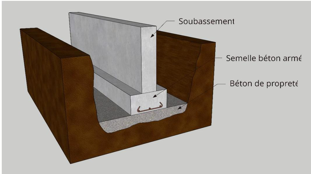
Il est important que la fondation se situe à une profondeur hors gel qui assure que le sol sous la fondation ne subira pas d'attaques causées par des cycles de gel-dégel. En Belgique, on considère une profondeur hors gel de 80 cm.
