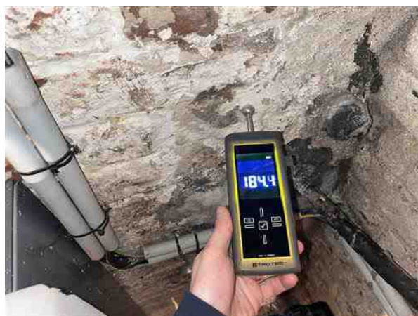
Photo 4 Avec notre testeur hygrométrique nous mesurons un taux d'humidité élevé sur le mur de la cave.
