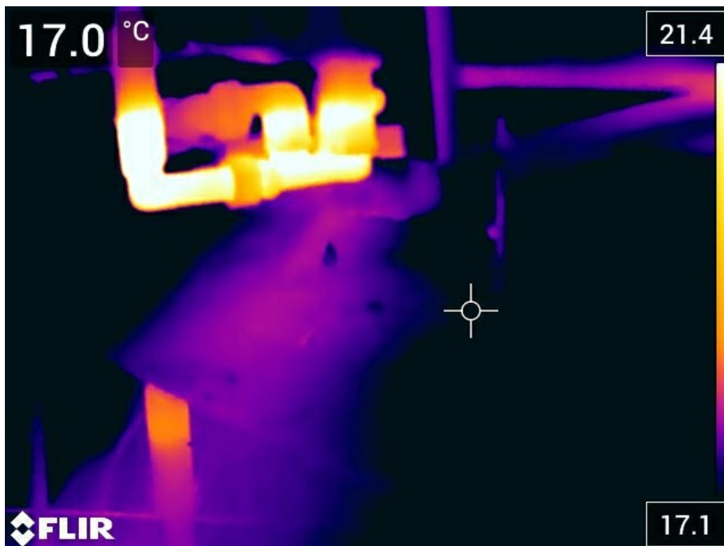
Photo 28 : lekindicatie op het warm watercircuit onder het bad
